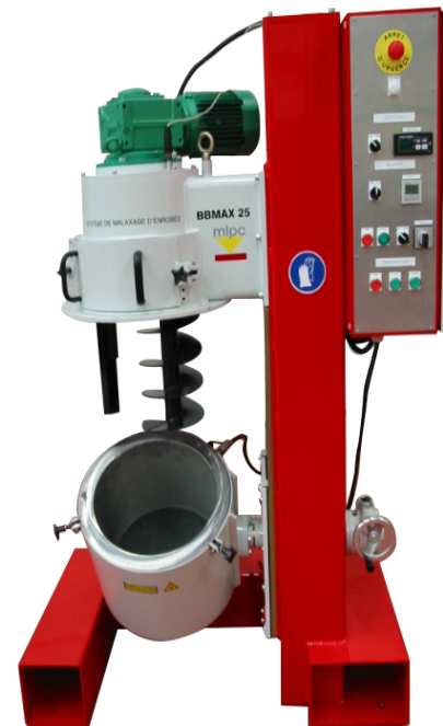
BBMAX 25, idéal pour la réalisations de petits échantillons (essais d'orniérage)
